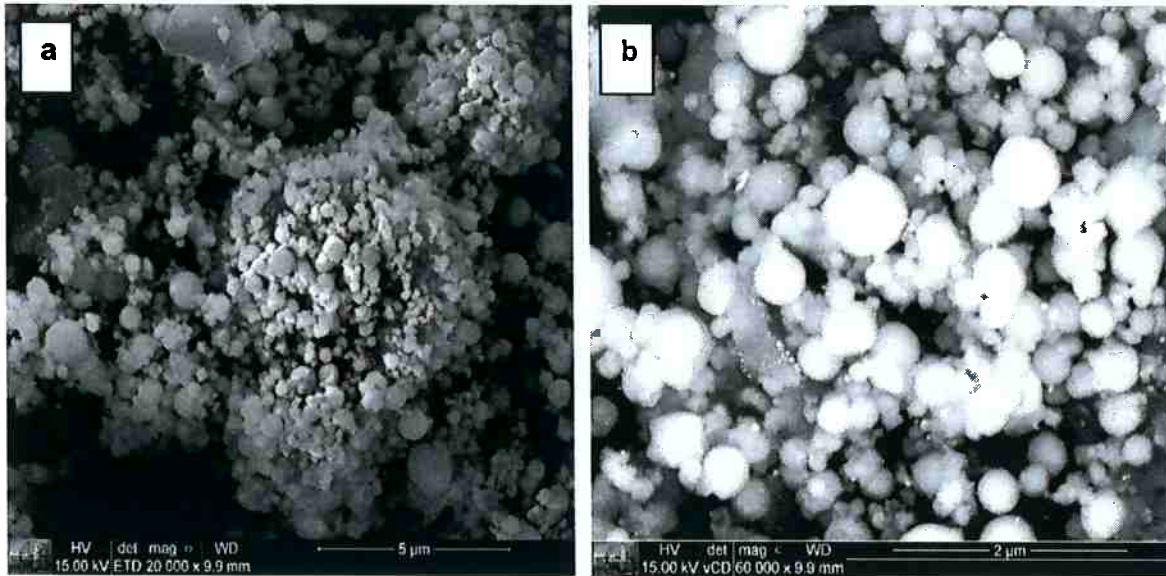
Figura 35. Micrografia obtida por microscopia eletrônica de varredura da pelota de PAE empregando coque de petróleo como agente redutor, após tratamento térmico a 450°C. a) elétrons retro espalhados. b) elétrons retro espalhados.
